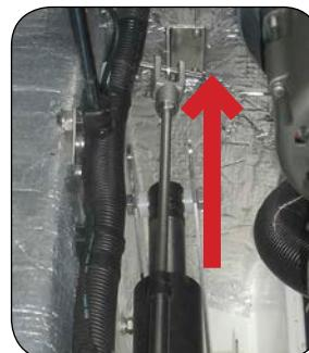
**Enlevez la goupille de sécurité, tirez manuellement le câble en avant, et fixez le câble avec la goupille dans le support situé devant, sur la cloison.**
