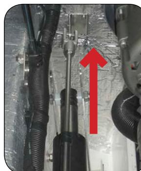
„Entfernen Sie den Sicherungs-stift, ziehen Sie das Kabel manuell nach vorne und setzen Sie den Stift auf der Vorwärts-Position wieder ein.“
